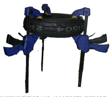
2) INVERT ASSEMBLY USING THE BEAMS AS 3 LEGGED SUPPORT
